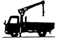
小型移動式クレーン(つり上げ荷重1トン以上5トン未満)運転の業務は、就業制限(安衛法第61条)の対象業務となり「小型移動式クレーン運転技能講習」を修了した者でなければ、その業務に就かせることができないことになっております。
